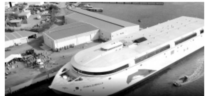
**U**n constructeur de bateaux australien a mis à l'eau vendredi ce qu'il décrit comme le plus grand navire électrique du monde, un mastodonte de 130 mètres capable de transporter plus de 2.000 passagers. Ce catamaran en aluminium baptisé Hull 096 est alimenté par plus de 250 tonnes de batteries, selon son constructeur, la société Incat. Les batteries et le système de stockage d'énergie fourniront plus de 40 mégawattheures de capacité installée.
