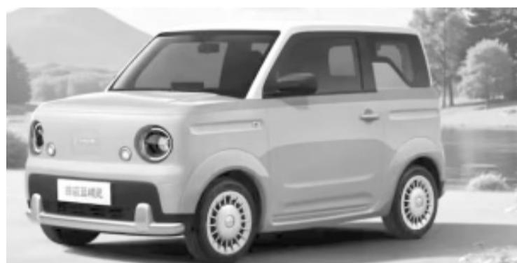
bleau de bord. Le moteur électrique développe une puissance modeste de 40 ch, ce qui permet à cette petite citadine d'atteindre une vitesse maximale de seulement 100 km/h. Grâce à sa batterie de 17 kWh, vous pouvez parcourir 200 kilomètres avec une charge complète.
